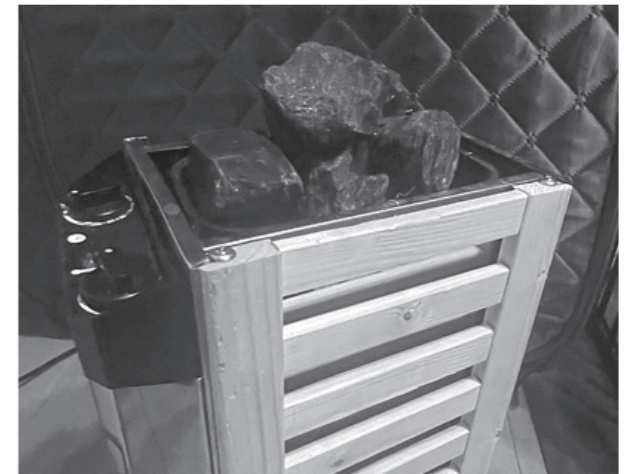
ガードを外してヒートチューブの上にストーンを載せています。こぶし大のストーン5個(約2kg)
